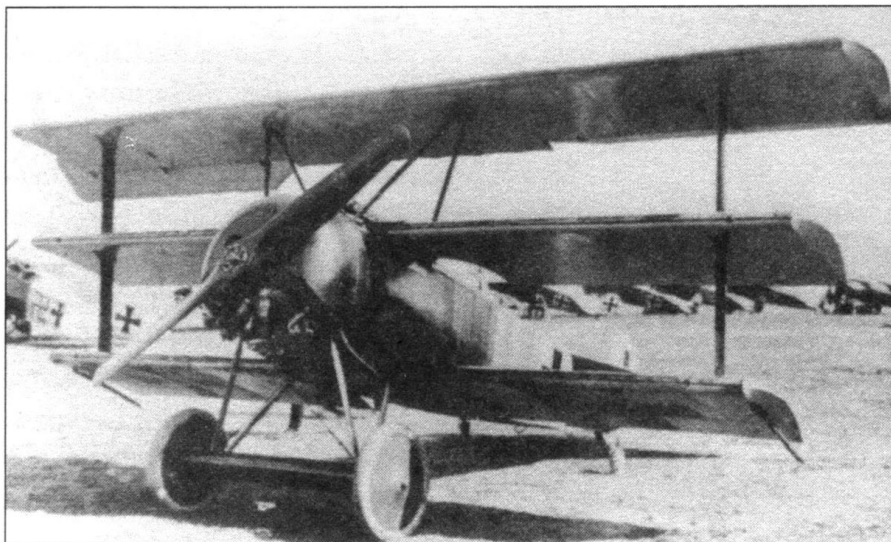
Снимок самолета Рихтгофена (Dr.1 477/17) сделан в тот же день, что и фотография линейки трипланов из Jasta 11. В красный цвет окрашены капот двигателя, диски колес, подкосы, верхняя поверхность верхнего крыла и, возможно, верхняя поверхность стабилизатора.
